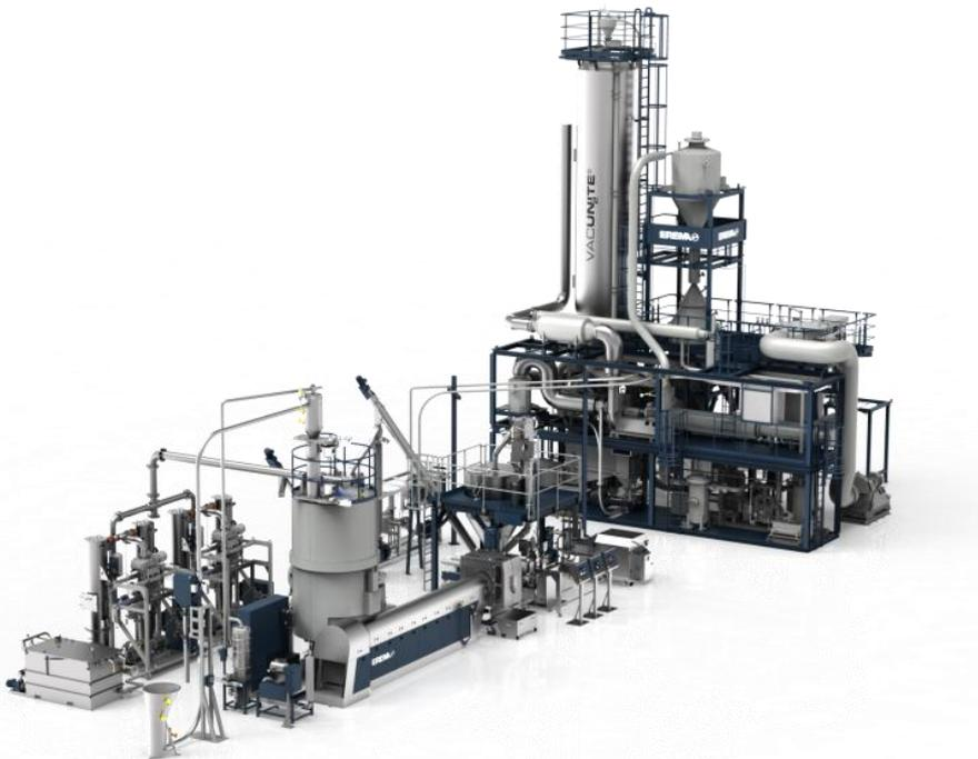
Bei VACUNITE® Anlagen kombiniert EREMA die bewährte VACUREMA® Technologie mit der Vakuum-unterstützten Stickstoff-SSP von Polymetrix.
