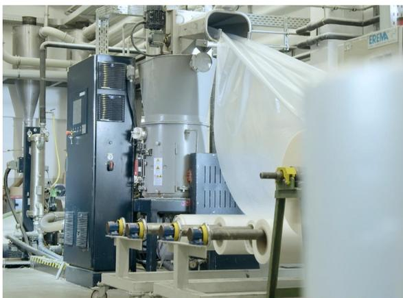
Bild 2: Die INTAREMA® K ist bei Coveris 24 Stunden pro Tag im Einsatz. Das recycelte Material wird zu 100 Prozent in die Folienproduktion rückgeführt. Fotocredits: EREMA
