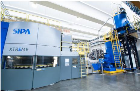
Bild 2: Die neue PET Inline Preform Anlage kombiniert die Effizienz-Vorteile der bewährten VACUREMA Technologie von EREMA mit dem innovativen XTREME Preform Production System von SIPA.
