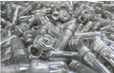
Bild 3: Mit der PET Inline Preform Anlage ist eine flexible Direktverarbeitung von PET Flakes zu lebensmittelkonformen Inline Preforms in nur einem Verarbeitungsschritt möglich.
