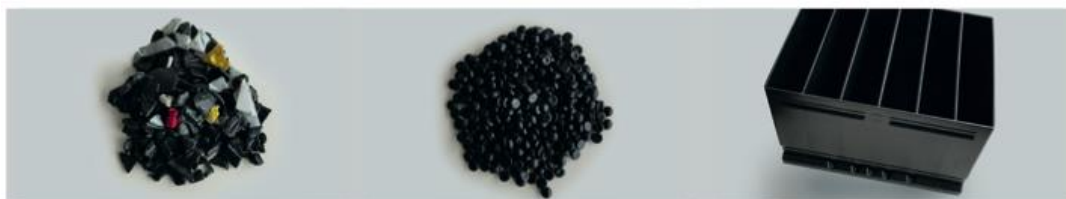
Inputmaterial: PP Polymere aus gesammelten, gewaschenen und gemahlten Autobatterien
