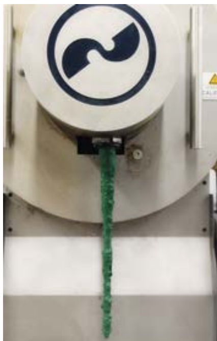
Der Laserfilter von EREMA hat ein kontinuierliches Selbstreinigungssystem.
