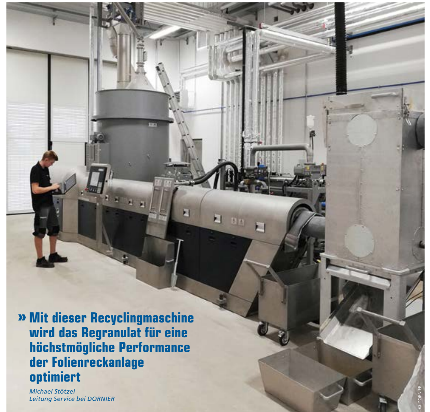
Das Recyclingsystem ist eine anwenderspezifische Kombination einer INTAREMA® 1512 TE Recyclingmaschine mit einem Schmelzefilter zur Feinfiltration von der Lindauer DORNIER GmbH.
