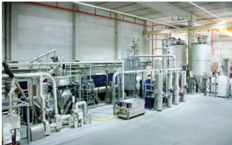
Mit der neuen VACUNITE® Anlage von EREMA erweitert die RCS Gruppe ihre Kunststoff-Recyclingsparte um die Herstellung von lebensmiteltauglichem PET-Rezyklat für Lebensmittel- und Getränkeverpackungen, Folien und Blister.
