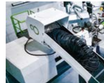
Als Material-Allrounder verarbeitet die ISEC evo Maschine sperrige Schlauchbündel ebenso wie Anfahrklumpen und Mahlgut oder komplette Rollen mit Tropfbändern.
