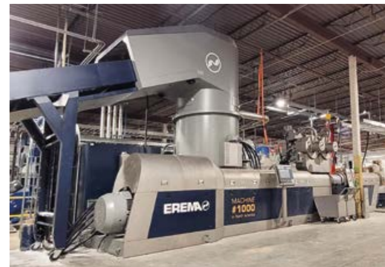
Bild oben: Die EREMA Jubiläumsmaschine wird bei PreZero US am Standort South Carolina für die Verarbeitung von gewaschenen LDPE Flakes eingesetzt.
