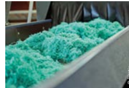
Erst wenn die Reststoffe möglichst sorten- und farbne getrennt, zerkleinert und gewaschen sind, werden sie in die Regranulierlinie überführt.
