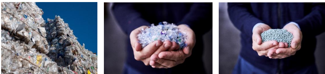
Bildtext: Im firmeneigenen Recyclingwerk "CIRREC" in den Niederlanden, werden die von Sammel- und Sortierunternehmen aus ganz Europa bezogenen PET-Ballen sortiert, gewaschen und recycelt. Die rPET-Flakes und das Regranulat werden sowohl an Verpackungshersteller geliefert als auch in der eigenen Produktion wieder eingesetzt. (copyright Faerch A/S)
