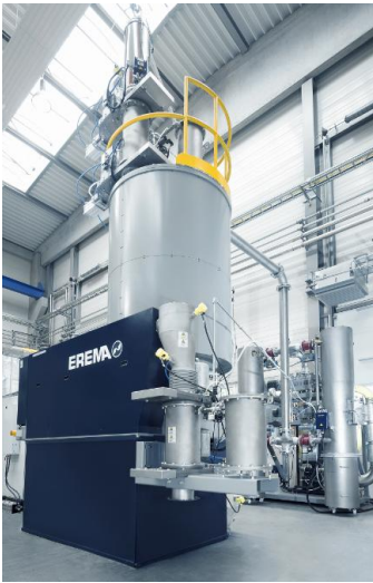
Bild 3: Der MPR von EREMA sorgt für die Dekontamination, Trocknung, Entstaubung und Kristallisation von unterschiedlichen PET Inputmaterialien noch vor der Extrusion. Fotocredit: EREMA, Humer / Wallmen
