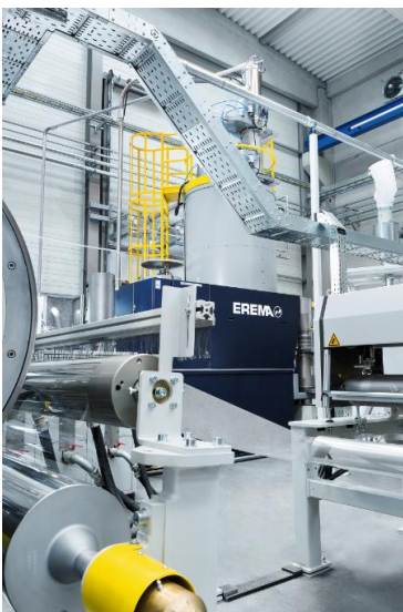
Bild 2: Alles in einem Arbeitsschritt: Das Inputmaterial gelangt vom MPR in das Extrusionssystem und wird im Anschluss direkt zu einem Inline Sheet Produkt verarbeitet. Fotocredit: EREMA, Humer / Wallmen
