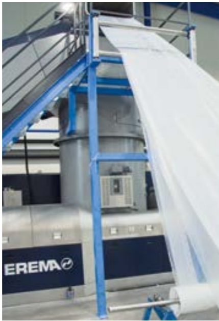
Según la tasa de utilización, la INTAREMA® cambia automáticamente de alimentación de material con cinta transportadora a dispositivo alimentador de bobinas.
