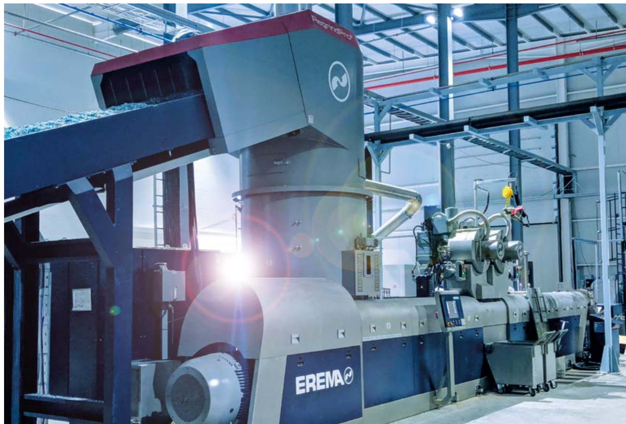
Filtro láser de EREMA para una filtración eficiente: las etiquetas de papel, aluminio o polímeros extraños procedentes de materiales multicapa, tales como PET o PA se eliminan eficazmente, incluso con grados de suciedad altos que llegan hasta el cinco por ciento.
