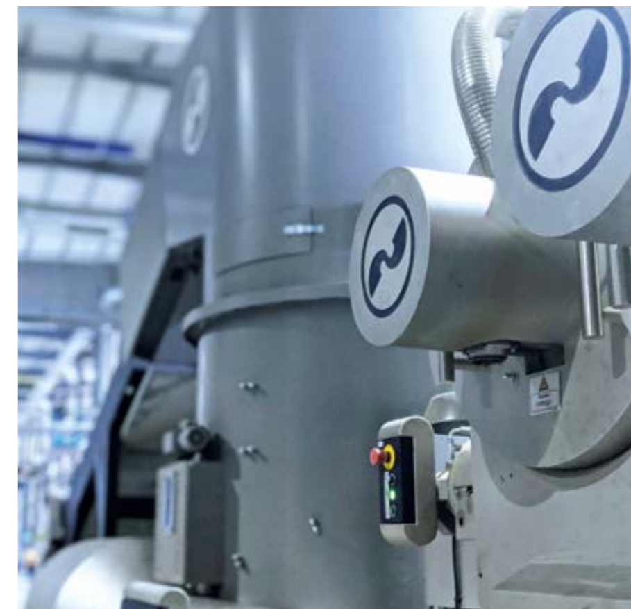
Filtro láser de EREMA para una filtración eficiente: las etiquetas de papel, aluminio o polímeros extraños procedentes de materiales multicapa, tales como PET o PA se eliminan eficazmente, incluso con grados de suciedad altos que llegan hasta el cinco por ciento.
